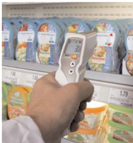
Při kontrole teploty zboží v regálu ohraňuje dvoubodový laser přesně místo, které měříte a zároveň ukazuje i jeho velikost.
