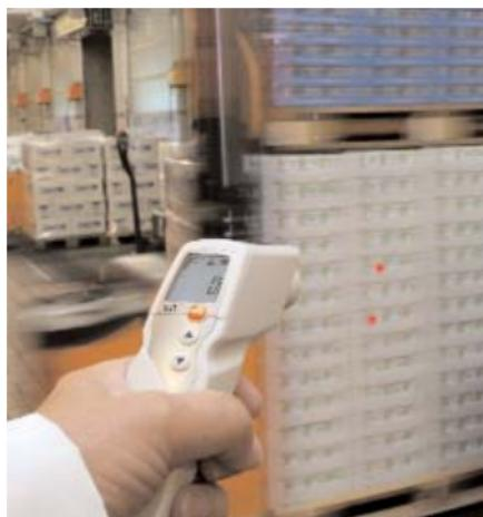
Typickým příkladem použití je rychlá kontrola teploty potravin při příjmu zboží, v prodejních regálech, lednicích nebo ve výrobě.
