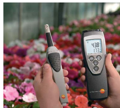
Vlhkovou sondu na rádiovou rukojeť při kontrole nastavení klimatizace
