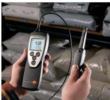
Vlhkovou sondu na rukojeti propojenou kabelem při kontrole ovzduší ve skladu
